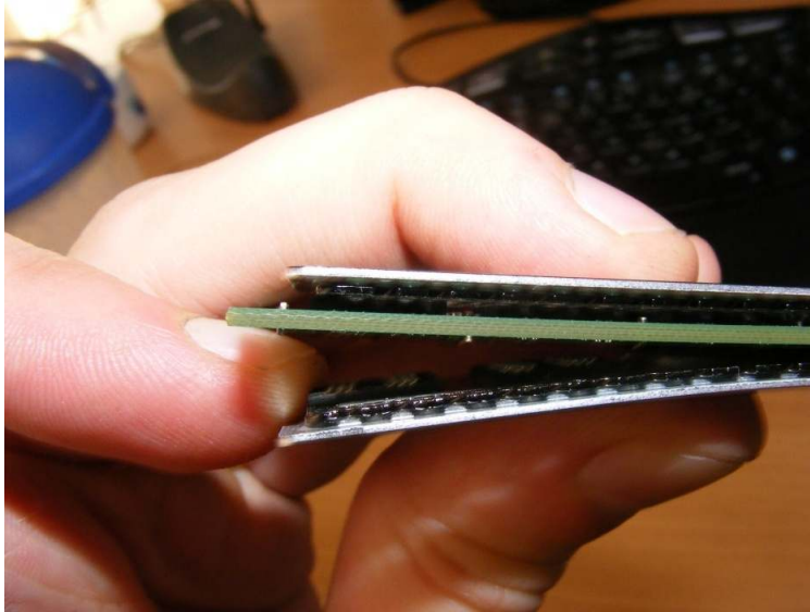
2) Uszkodzone styki (piny) pamięci (wypalone, brak, uszk. Mech)
